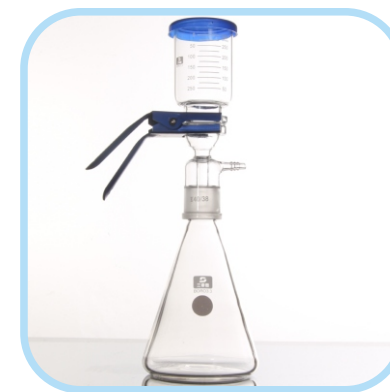
砂芯过滤装置
