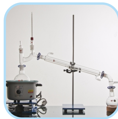
减压蒸馏装置
